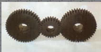
Riduttore a pignoni (in bagno d'olio) dopo il riduttore epicicloidale.
