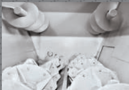
4 coclee: 2 inferiori con coltelli 2 superiori per miscelare.
